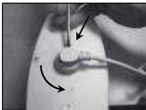
A l'aide d'un outil de type tournevis, débloquer (comme indiqué sur l'image) en appuyant dans l'encoche. En même temps, tourner la bague dans le sens des aiguilles d'une montre pour déverrouiller la prise.
