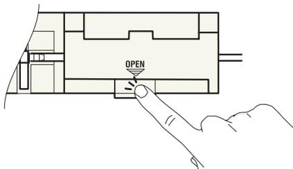
Pour Rythmic™ Organiser: soulever le verrouillage de sécurité. Appuyer sur le levier d'ouverture pour ouvrir le volet de protection du système de pompage.
