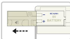
1 Faire glisser la fenêtre du compartiment de la pile vers l'extérieur de la pompe dans le sens de la flèche marquée BATT.
