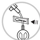
3. S'assurer que la seringue soit vissée en butée de la valve du site de remplissage
