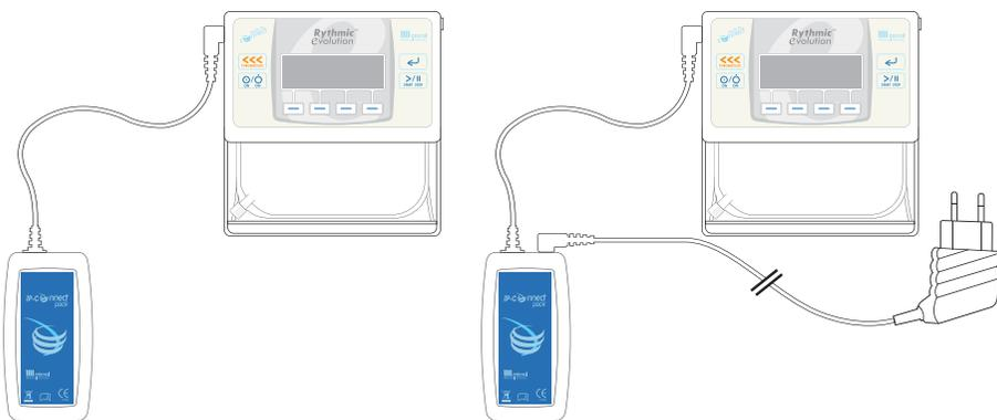
Le fonctionnement de l'IP Connect Pack n'interfère pas avec celui de la pompe. La bonne connexion et le fonctionnement de l'IP Connect Pack peuvent se vérifier par la présence sur l'écran principal de la pompe, lorsque celle-ci est en "EN PAUSE" ou
