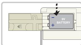
2 Insérer la pile dans le compartiment réservé à cet effet, en vous assurant de respecter la polarité à l'aide des symboles +/-.
