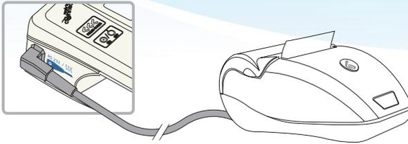
3. Mettre l'imprimante sous tension en appuyant sur la touche située sur la partie avant de l'appareil pendant quelques secondes, jusqu'à ce que le voyant s'allume.
