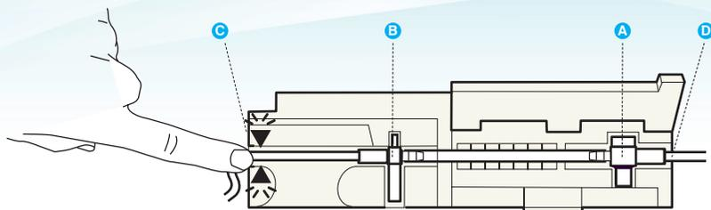
**5.** Fermer le volet de protection du système de pompage. Pour Rythmic™ Organiser: appuyer fermement pour actionner le verrouillage de sécurité.
