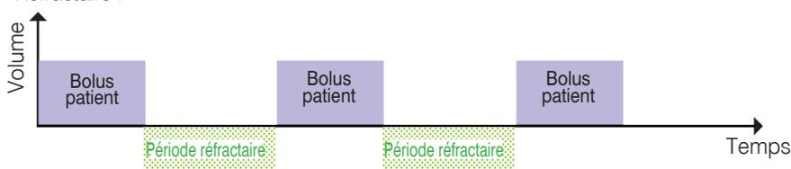
**Bolus Auto.** (signifiant Bolus Automatique Programmé ou "PAB"), ce mode de perfusion donne la possibilité de perfuser de manière automatique et périodique une dose de Bolus prédéfinie en plus d'un débit de base éventuellement programmé. Ce mode permet d'activer et de programmer les paramètres de Débit de Base, volume du Bolus Automatique, Fréquence du Bolus Automatique, volume du Bolus Patient, Période Réfractaire, Dose Limite et Limite Bolus et de Volume à Perfuser.
