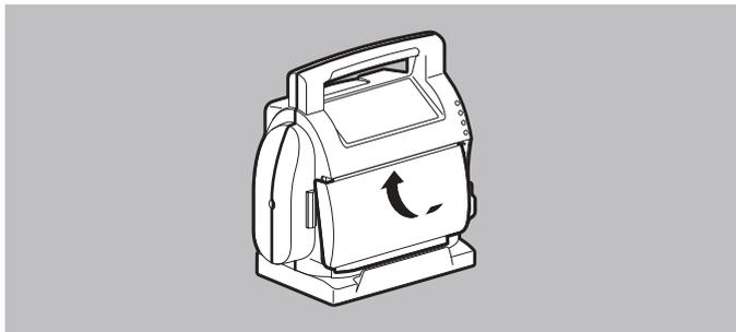
1. Insérer le couvercle du compartiment à batterie dans le guidage supérieur du compartiment à batterie.
