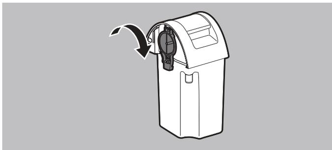
7. Tourner le porte-filtre à fond dans le sens des aiguilles d'une montre.
