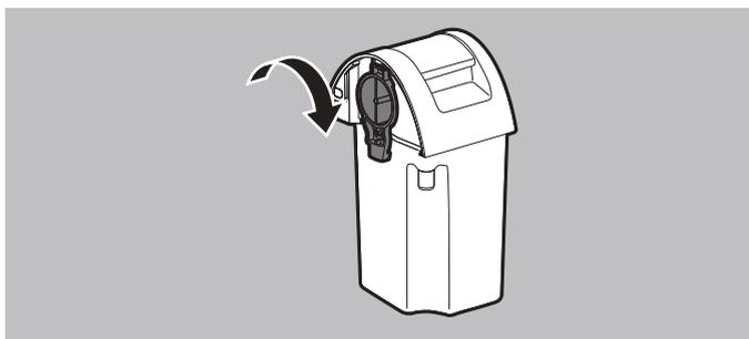
10. Tourner le porte-filtre à fond dans le sens des aiguilles d'une montre.
