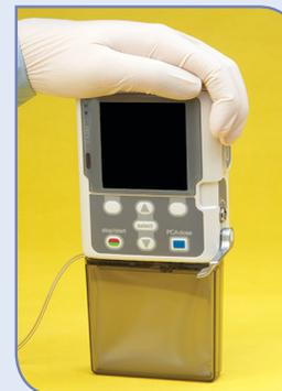
5. Relevez le levier de la pompe en position fermée. En cas de résistance, déverrouillez le consommable et renouvelez l'opération. En cas d'échec à la deuxième tentative, n'utilisez pas la pompe et contactez le Service Client de Smiths Medical pour obtenir une assistance.
