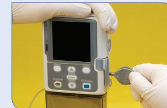
6. Si vous souhaitez verrouiller la cassette, insérez la clé de la pompe dans la serrure de verrouillage et tournez-la dans le sens des aiguilles d'une montre.
