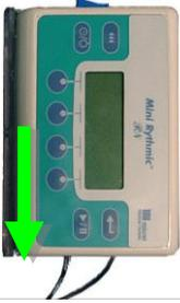
Insérer la tubulure dans la pompe et mettre sous tension, saisir le code de programmation et valider.
