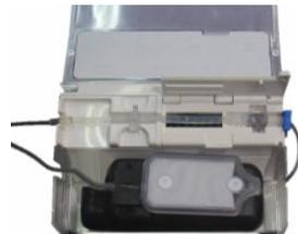
Positionner la tubulure dans le système de pompage, la membrane du capteur de pression(1) vers le bas, le détrompeur (2) correctement orienté et la partie connectée au flacon sortant vers le fente (3).
