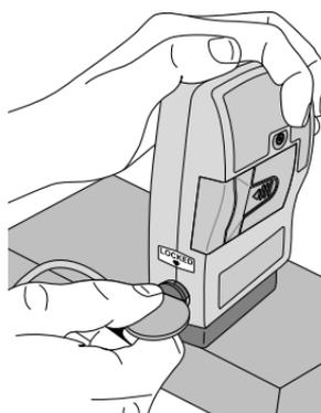
4. Insérez une pièce de monnaie dans le bouton de blocage, enfoncez et tournez dans le sens inverse des aiguilles d'une montre, jusqu'à ce que le repère du bouton soit aligné avec la flèche et que vous sentiez le bouton se mettre en place avec un déclic.
