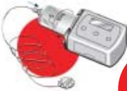
**CRONO Super PID** est munie d'un afficheur à cristaux liquides (écran) qui indique les informations relatives au temps restant de perfusion, au type de seringue et à l'état de charge de la batterie.
