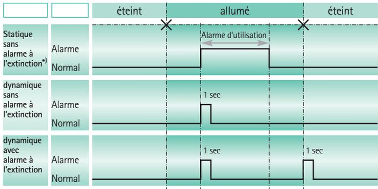
\*) en mode statique sans alarme à l'extinction, le renvoi d'alarme peut être supprimé par
