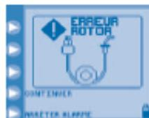
Chargement incorrect de la tubulure du set pompe sur le rotor ou dysfonctionnement du rotor
