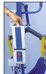
. Brancher le câble secteur fourni, à la **connexion câble secteur ⑦** du boîtier de contrôle.
