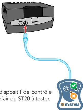
Brancher le dispositif de contrôle sur la sortie d'air du ST20 à tester.
