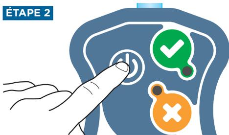
Mettre en marche le dispositif de contrôle en appuyant sur le bouton **1** FIG. 1.
