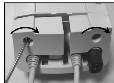
3/ Visser le capot au boîtier de contrôle à l'aide d'un tournevis cruciforme.
