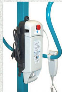
Descente électrique d'urgence à actionner si la batterie ne permet plus de soulever le patient
