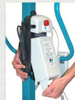
Sortir la batterie en tirant vers l'avant. Faire l'opération inverse pour remettre la batterie
