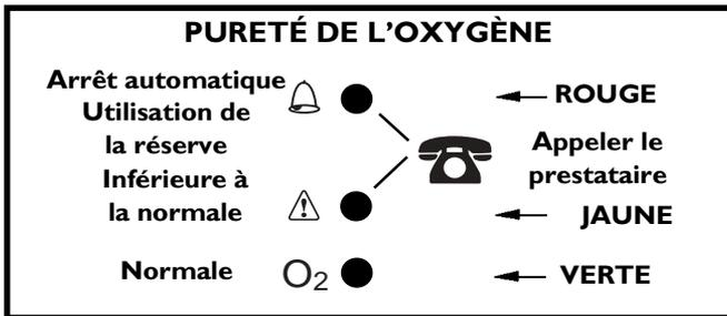
**FIGURE 5.7** Indicateurs de pureté de l'oxygène SensO<sub>2</sub> (Modèle de capteur d'oxygène LX)
