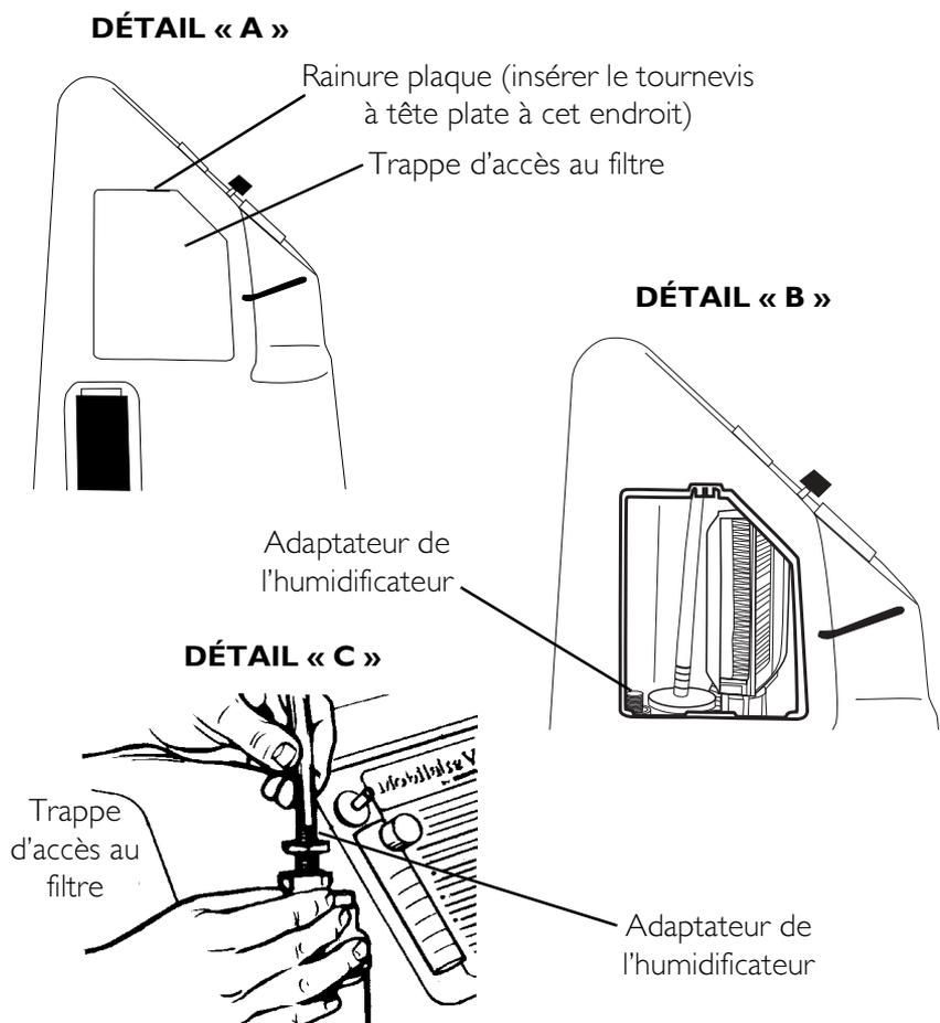
**FIGURE 5.3** Fixer l'adaptateur de l'humidificateur
