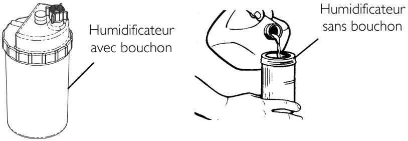
**FIGURE 6.1** Remplissage de l'humidificateur
