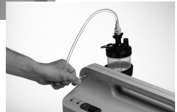
4. Mettez l'interrupteur d'alimentation en position Marche [I]. Initialement, tous les voyants DEL s'allument et l'alerte sonore retentit pendant quelques secondes. Ensuite, seul le voyant DEL vert doit rester allumé. Cet appareil nécessite généralement 10 minutes pour atteindre les spécifications de pureté de l'oxygène.
