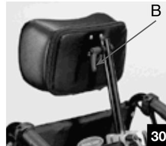
**Nota :** Il est escamotable pour plier le fauteuil, desserrez légèrement le bouton (A), tirez vers le haut et faites pivoter jusqu'à la position verticale, le long du dossier.
