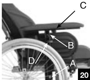
**Nota :** l'ajustement de la protection latérale est nécessaire en fonction de la hauteur choisie, dévissez légèrement les vis (D) et faites coulisser l'ensemble jusqu'à la nouvelle position, resserrez fermement (D).
