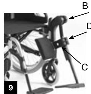
La palette peut être articulée par platine crantée (en option), desserrez la vis (B), réglez à l'angle voulu et resserrez fermement.
