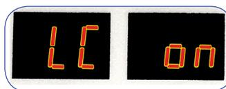
**Verrouillage automatique du clavier** : après 3 minutes de non utilisation. Lorsqu'il est activé, toutes les touches sont désactivées et **LC on** apparaît à l'écran si l'on appuie sur l'une des touches.
